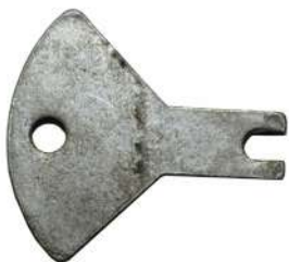
Ключ от электрошкафа
